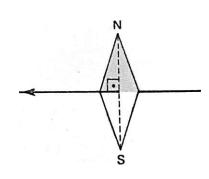
65.Una aguja magnética, con un orificio en su centro, es atravesada por un conductor, como indica la figura, por el que circula la corriente. La aguja puede girar libremente con eje en el orificio. Según ello, podrás asegurar que la aguja:
